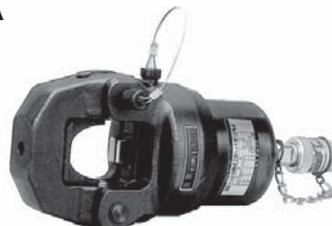
■公称出力:226kN(23tf) ■適用範囲:60~325mm<sup>2</sup> ■全長・質量:210mm・7.5kg ■標準ダイス:オス 22-60-70-100-150-325、メス 60-80-100-150-180-200-325 ■備考:JIS C 9711、オスダイス8-14、メスダイス82・14・22・38・70はオプション、油量85cm<sup>3</sup>(85cc)、スチールケース付
