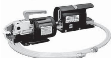
手動工具を圧搾空気利用により簡易能率化したものです。軽量携帯型で迅速・安全・連続的に電線の端子を接続することができますので特に流れ作業には便利です。また、ヘッド交換により各種の大きさや型の端子を圧着することができます。
